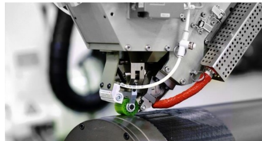
Abb. 2 Towpreg-Legevorgang bei der Herstellung von faserverstärkten Bauteilen mittels AFP-Anlage 2
